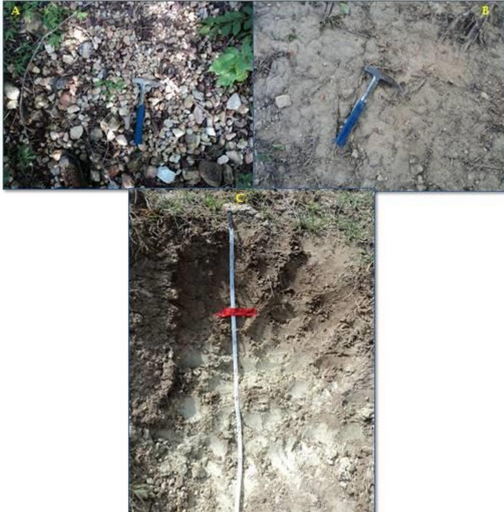
Fotografía 1.4. Depósitos Qfal, encontrados en Mosquito 2. A) Gravas, B) Arenitas finas y C) lodos
